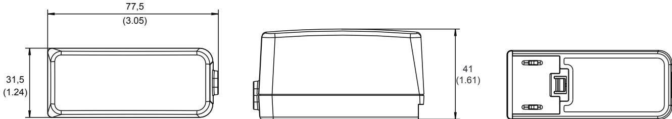
Alle Abmessungen in Millimeter (Inch), Abweichung ± 0,5 (0.02)
