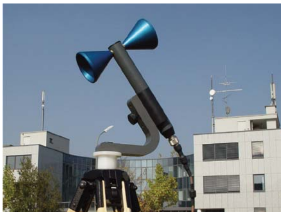
Medidas con la 9170 Biconical Antenna
