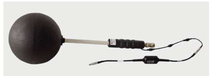
Las medidas de captación (exposición a la radiación) se realizan sin dificultad mediante una antena isotrópica
