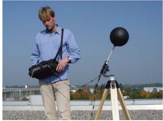
Mesures avec l'analyseur de spectre portable et la 9171 Isotropic Antenna
