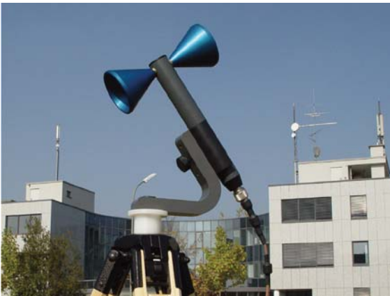
Mesures avec la 9170 Biconical Antenna
