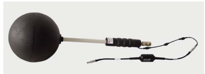
Les mesures d'immission sont faciles à effectuer avec l'antenne isotrope.
