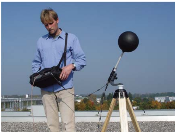
利用手持频谱分析仪和9171全向形天线进行测量
